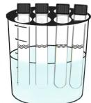
6 冷却完成后依次加入0.5ml总氮试剂(C), 加盖摇匀。
